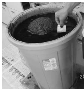
図6 すくも藍による天然灰汁発酵建て藍窯と糸染色
