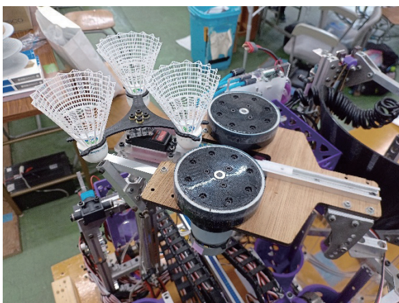
図9. 射出機構および次弾装填機構
